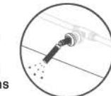
**ES** Sistema de nebulización de vapor integrado en el perímetro de la estructura. La presurización del agua se produce mediante una bomba de alta presión. Gracias a las boquillas nebulizadoras patentadas se puede crear una niebla ultrafina formada por millones de gotitas de un tamaño medio inferior a 10 micrones. Estas gotitas ultrafinas, al evaporarse, absorben rápidamente el calor presente en el ambiente circundante refrescando el ambiente subyacente.
